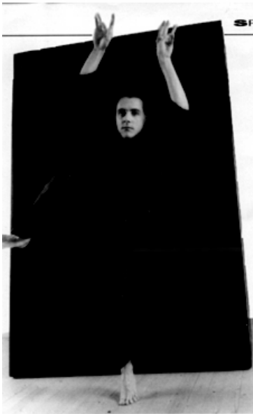
Bruno Verdi devant son Monolith. Le Monolith capte les gestes du danseur par l'intermédiaire de cellules photo-sensibles, puis ces informations sont transformées en signaux midi qui vont aller piloter un synthétiseur.
